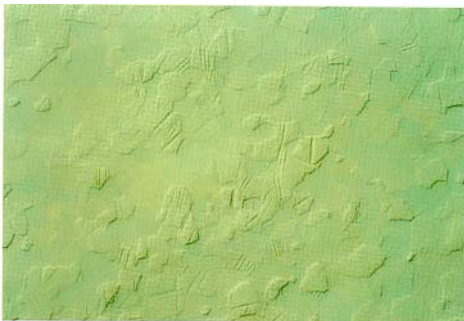
Bild 3.2.1 Kurze Verformungslinien, auf einzelne Körner beschränkt 100x
