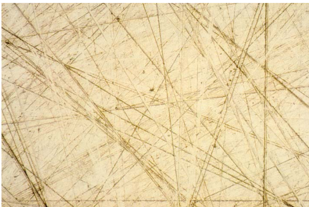
Bild 3.1.1 Nach dem Feinschleifen, Kratzer vom Planschleifen sind noch sichtbar 200 x
