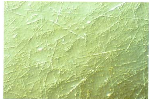
Bild 3.2.2 Gut ausgebildete, scharfe Verformungslinien 200x
